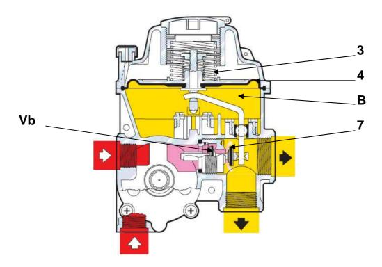
Газ при требуемом настроечном давлении выходит из регулятора к потребителям через выходные фитинги  ${\bf U}.$
