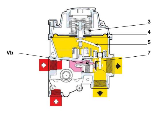
Изменения давления, увеличение или уменьшение, обусловленные большим или меньшим расходом, зарегистрированные посредством отбора импульса в камере **B**, изменяют равновесие, созданное между усилием, оказываемом на мембрану **4** и усилием противодействия пружины **3**, удаляя или приближая уплотнение **7** седла клапана **Vb**, выводя его на то положение, что позволит восстановить равновесие между двумя противодействующими усилиями, приводя, как следствие, давление к настроечным уровням.
